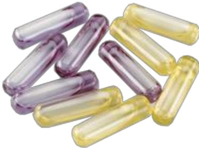
El control negativo es una ampolla de medios de comunicación a partir de la misma cantidad de medios que se utilizan para hacer las ampollas de esporas correspondientes. Controles negativos pueden ser utilizados en una de dos maneras diferentes:
